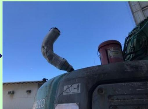
装置内用活性炭材料作滤网，利用活性炭特性过滤多余的排气污染物（包括悬浮粒子、二氧化硫及氮氧化物等等）
